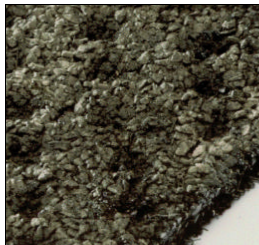
Abb. 5: Erosionsschutzmatte mit offener Struktur (Enkamat 7010) und werksseitig mit Splitt-Bitumen-Gemisch verfüllte Erosionsschutzmatte (Enkamat A)
